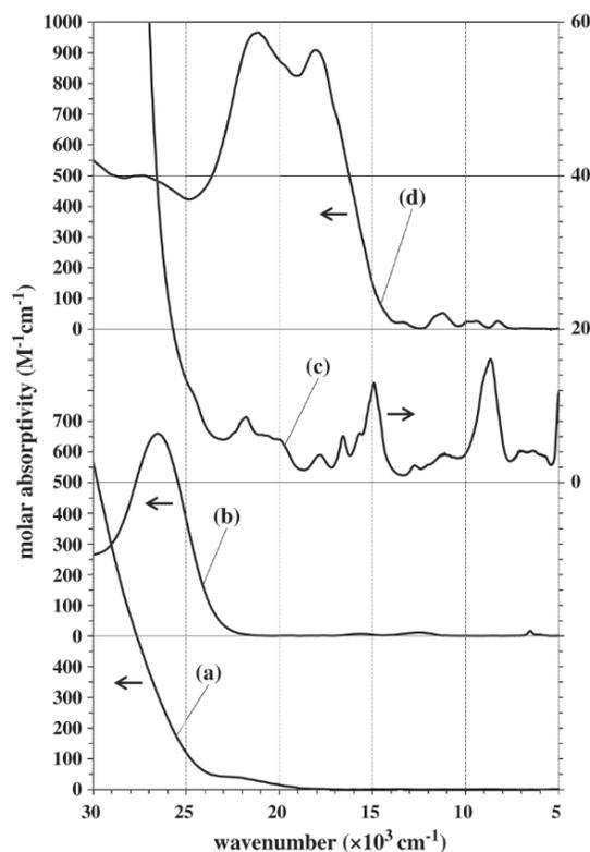
**Figure 2-3.** The absorption spectra of (a)  $\text{UO}_2^{2+}$ , (b)  $\text{UO}_2^+$ , (c)  $\text{U}^{4+}$ , (d)  $\text{U}^{3+}$  in LiCl-RbCl eutectic melt at  $400^\circ\text{C}$ . From Nagai et al.<sup>7</sup>
